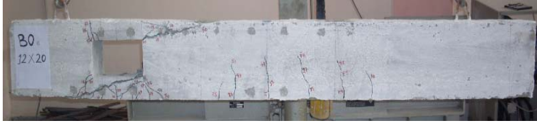
الشكل (12) نمط التشققات والانهيار في الجائز B6
