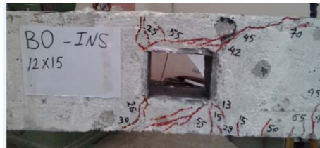
الشكل (10) الانهيار في الجائز B4
