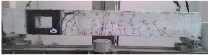
الشكل (8) نمط التشققات والانهيار في الجائز B2
