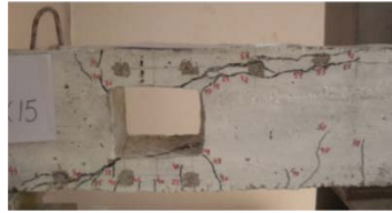
الشكل (8) نمط التشققات والانهيار في الجائز B2
