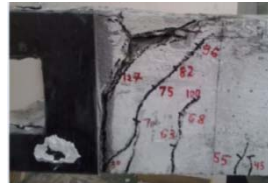
الشكل (9) الانهيار في الجائز B3
