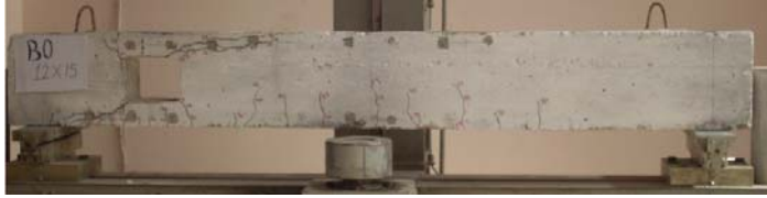
الشكل (7) أنماط التشققات في الجائز B1
