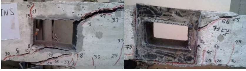
الشكل (15) الانهيار في الجائز B5
