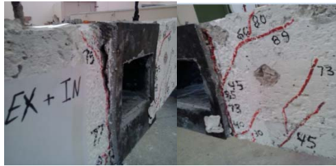
الشكل (11) الانهيار في الجائز B5
