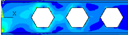
الشكل (33) : إجهادات (SEQV) في حالة الحواف الحادة
