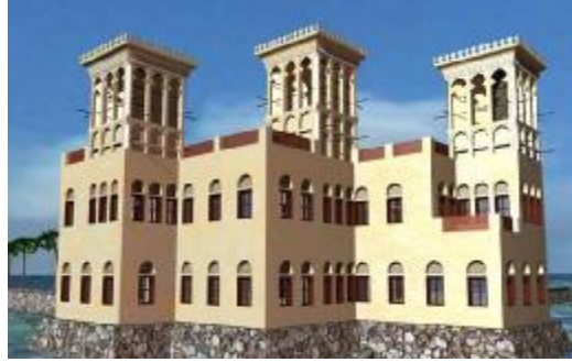
الدراسة المعمارية عكست الناحية البيئية من خلال استخدام عناصره واستخدام مواد بناء تراعي هذه الناحية ( حجارة - طينة - GRC - GFC )
