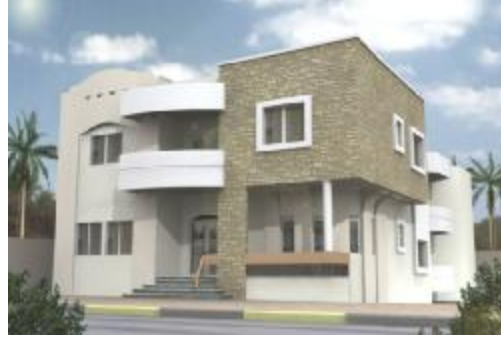
استخدام الحجر كمادة للإكساء بدلاً من الإنشاء
